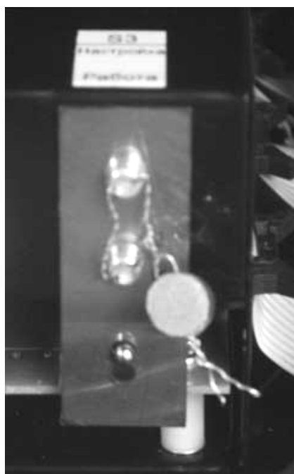
Рис.3. Пломбировка тумблера «Настройка/Работа» блока управления
