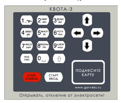
6.3. Зона считывания магнитных карт предназначена для бесконтактного считывания электронных магнитных карт.
