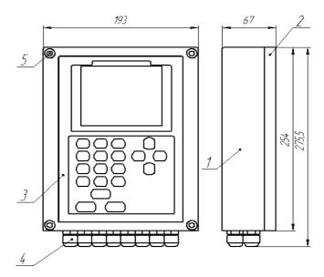
На корпус 1 установлена крышка 2, закрепленная болтами 5. Для предотвращения самопроизвольного раскручивания болтов используются гроверные шайбы.
