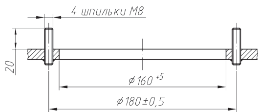
Эскиз доработки крышки резервуара для установки ППП
