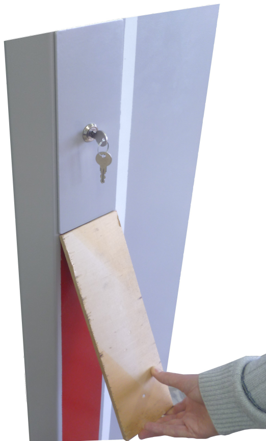
Фото 9 — Вскрытие замочного отсека.
